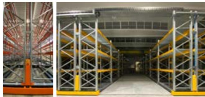
scorrere su guide fisse, posizionate sul pavimento, consentendo la creazione di corsie di carico. In questo modo, gli operatori possono accedere solo alla corsia di carico che serve per il prelievo o la messa in magazzino delle merci, senza dover spostare tutto il carico di scaffali, come accade nei tradizionali sistemi di scaffalatura.
